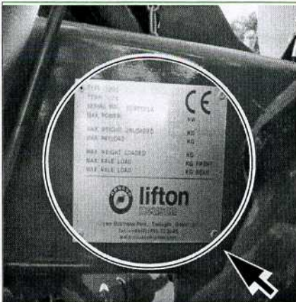
Fig. 1: Posición de la placa de características
